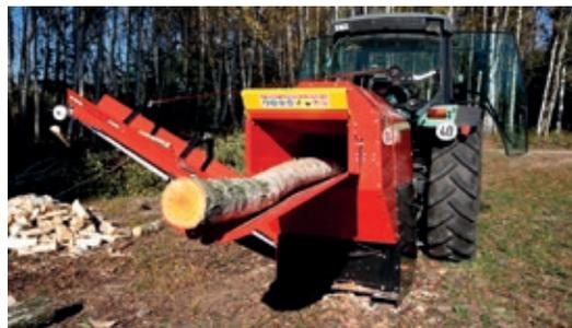
■ Der Holzhackern und -spalter RP-300 ist ein effizientes Gerät zum Schneiden und Spalten des Holzmaterials von bis zu 20 cm Stärke.
