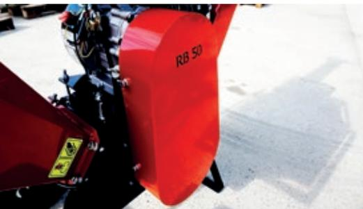
■ Die Verbrennungshäcksler RB-50 und RB-100 verfügen über eine Fliehkraftkupplung (Reibungskupplung), die den Start erleichtert und die Häcksler vor Überlastung schützt.
